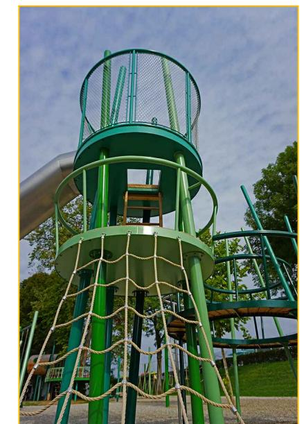
Maximale freie Fallhöhe des Gerätes: 1,80m
