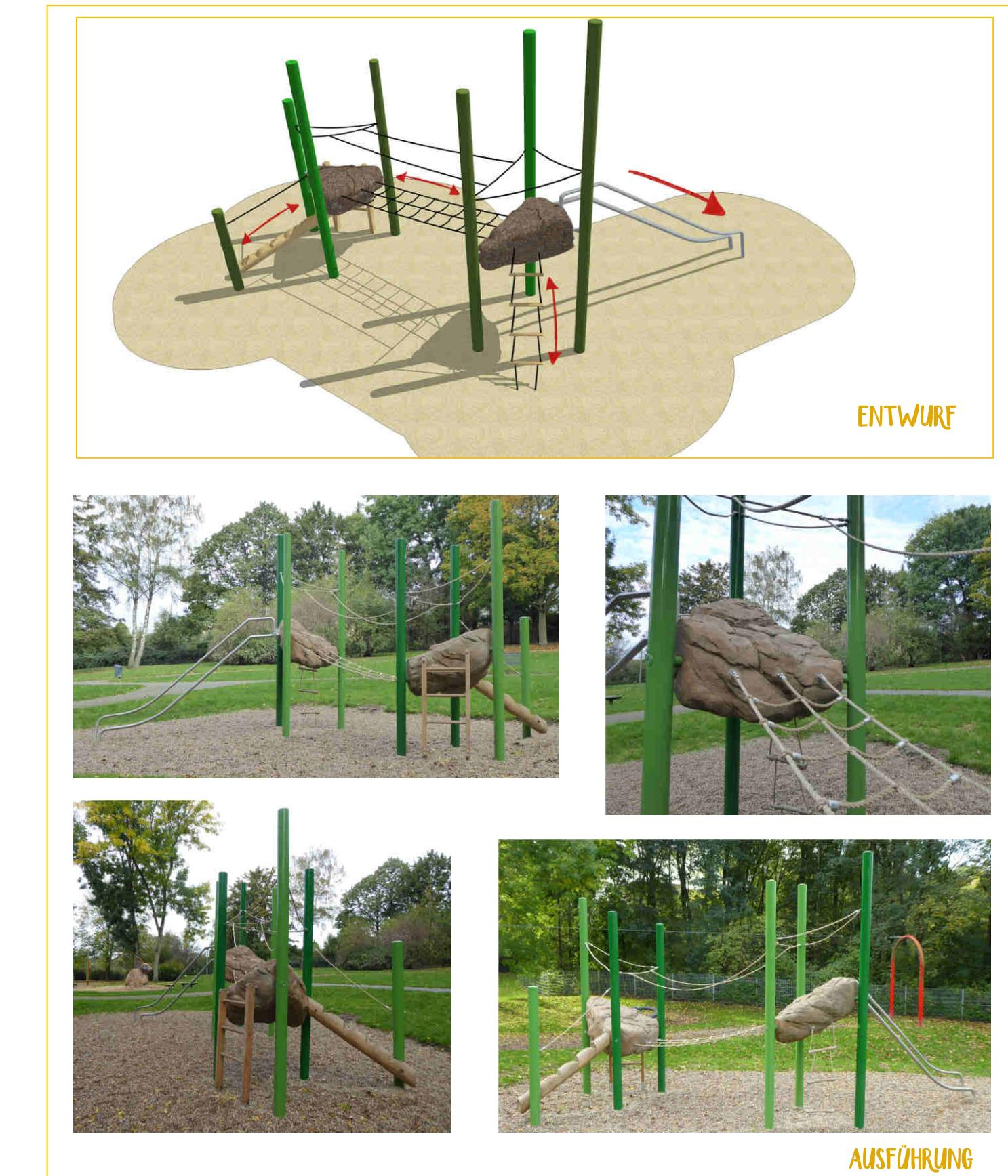
Maximale freie Fallhöhe des Gerätes: 1,90m
