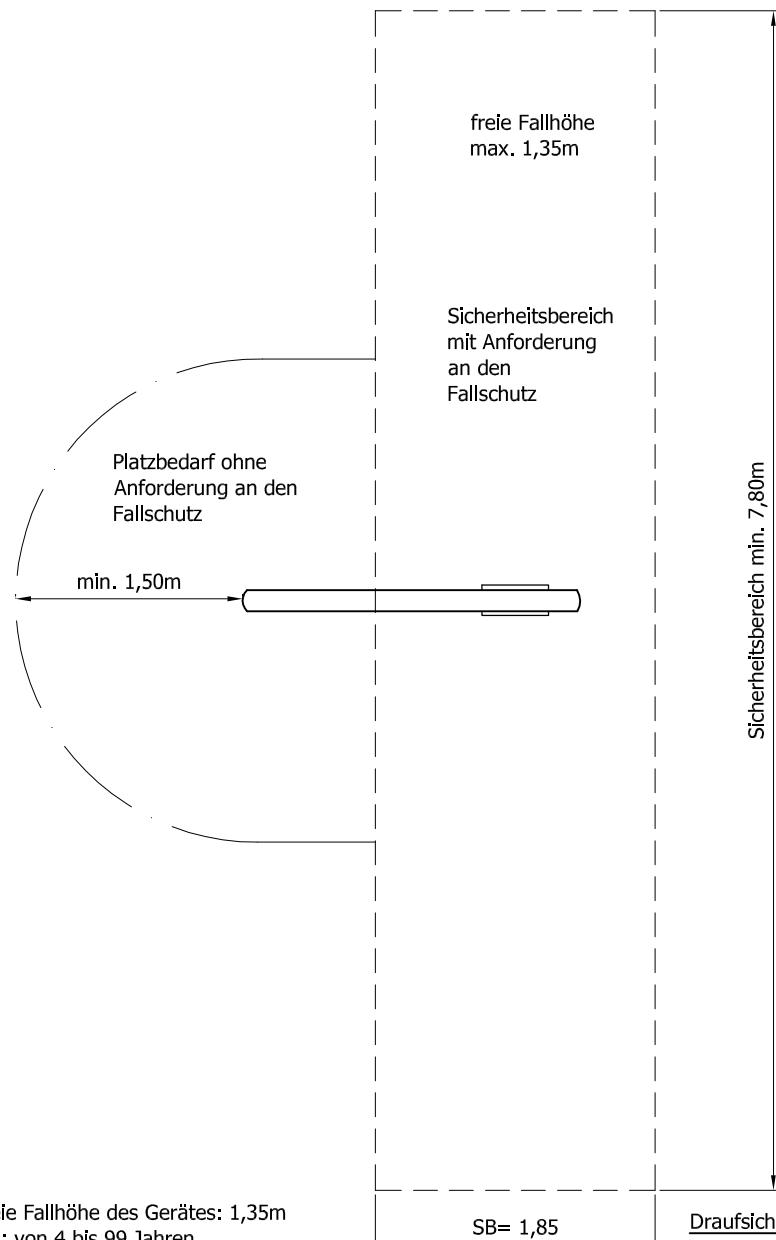
Maximale freie Fallhöhe des Gerätes: 1,35m
