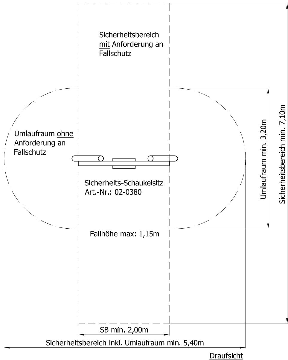
Maximale freie Fallhöhe des Gerätes: 1,15m
