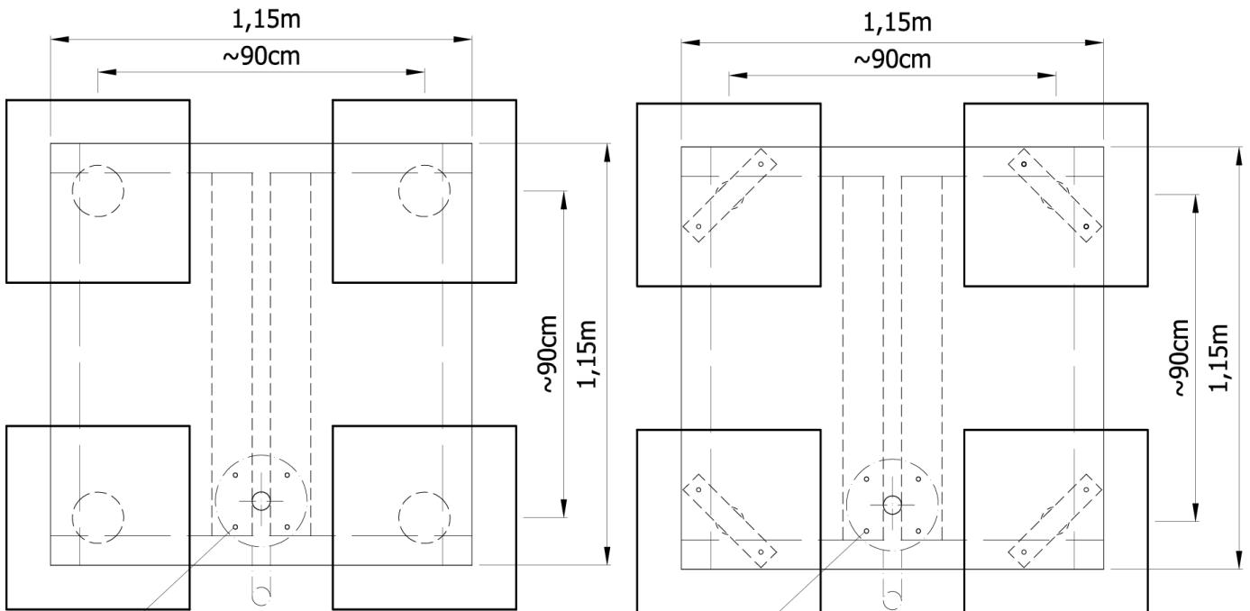
Bohrungen ø12 für Patentpumpe
